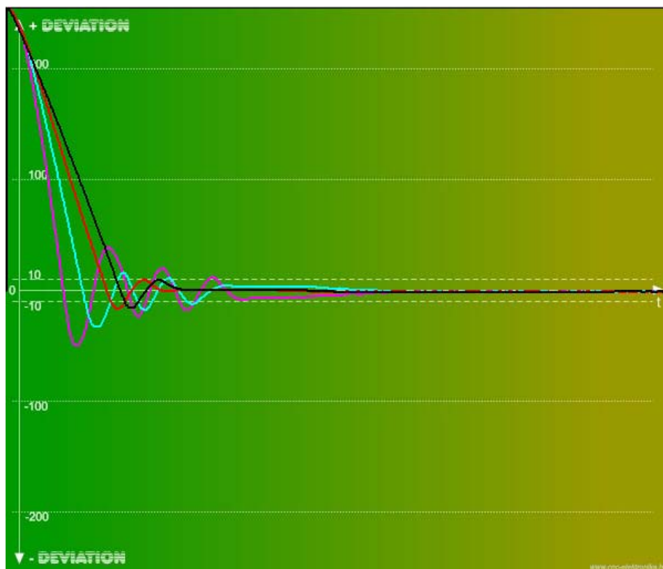
(Teszt gombra adott, változó D-tagú, mechanikai beállítás görbéje)
