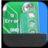
(Error + GND + E-Stop csatlakozó)
