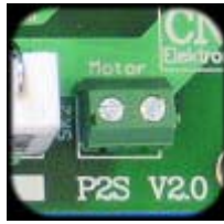
(Motor csatlakozója)
